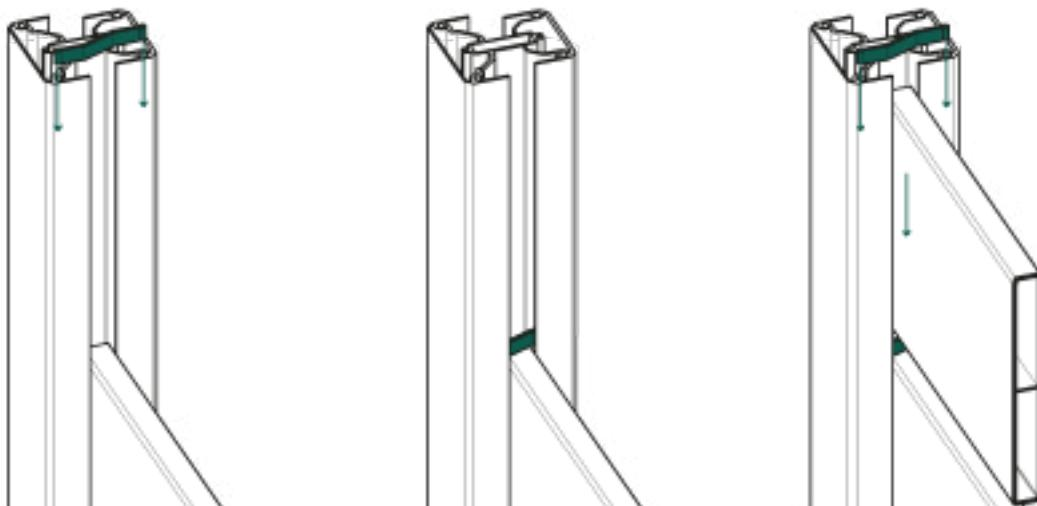
Uma vez fixados os postes da nossa instalação, procederemos à colocação das ripas. Estas serão colocadas na ranhura do poste e deslizarão para a posição correspondente. Antes de colocar a lâmina seguinte, devem ser colocados os separadores como se mostra na ilustração, utilizando as guias de fixação dos separadores que o poste tem na sua estrutura. Estes espaçadores devem ser colocados apenas entre as tábuas. A distância necessária entre a última tábuas e o topo do poste é de 20 mm.
