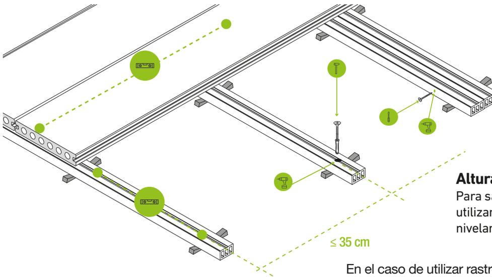
Para fijarlos al suelo podemos taladrar el rastrel y el hormigón, colocando un taco de impacto que sujete ambos o utilizar colas de poliuretano en caso que no podamos taladrar el suelo existente.
