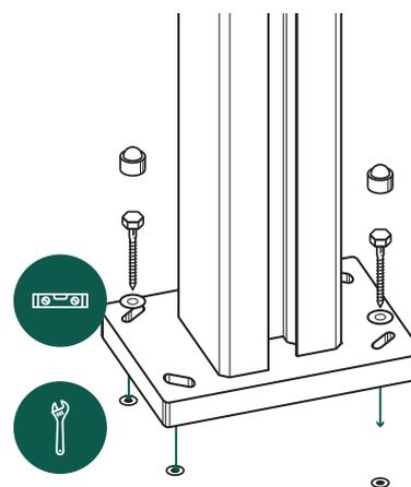
3. Nivelar y fijar el poste al suelo con cuatro tornillos y arandelas. Utilizar los embellecedores para cubrir cada tornillo.
