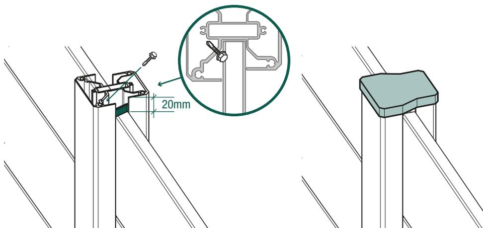
Para concluir la instalación, asegúrese de colocar el tornillo de fijación de las lamas y la tapa de la parte superior del poste suministrada en la caja de accesorios. Para una mayor sujeción aplique adhesivo de montaje en el acople de la tapa.
