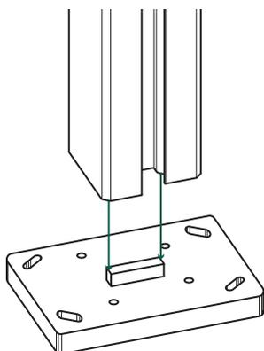
4. Posicionar el poste en la base para su montaje, haciendo coincidir la marca de la base con su correspondiente hueco en el poste.
