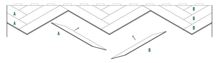
Los enganches entre piezas se realizarán insertando la lengua del borde de una pieza en la ranura de la adyacente. Para que las piezas que se coloquen estén perfectamente encajadas, deberá utilizarse tras cada ensamble un bloque percutor y un martillo golpeador para cuadrar las uniones y que no haya huecos. No utilice el martillo golpeador solo, sin bloque percutor, para no dañar las piezas.
