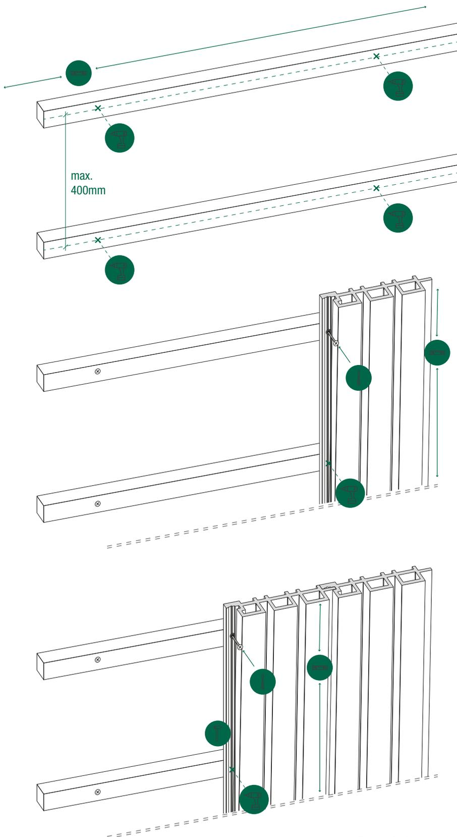
Para la instalación interior es posible prescindir de rastreles siempre y cuando la superficie donde se instalen se encuentre lisa y completamente a plomo.
